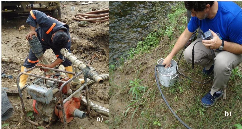
Figura 25 a) Acoplamiento de mangueras b) Sonda multiparamétrica
