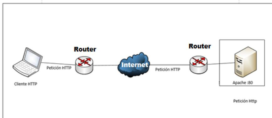
Figura 1.3 Esquema de comunicación del puerto 80
