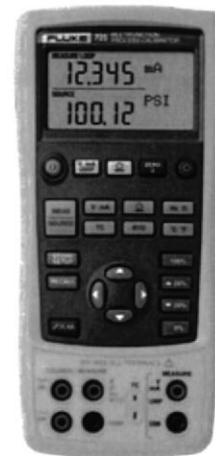
Figura 3.8 calibrador de procesos fluke 725
