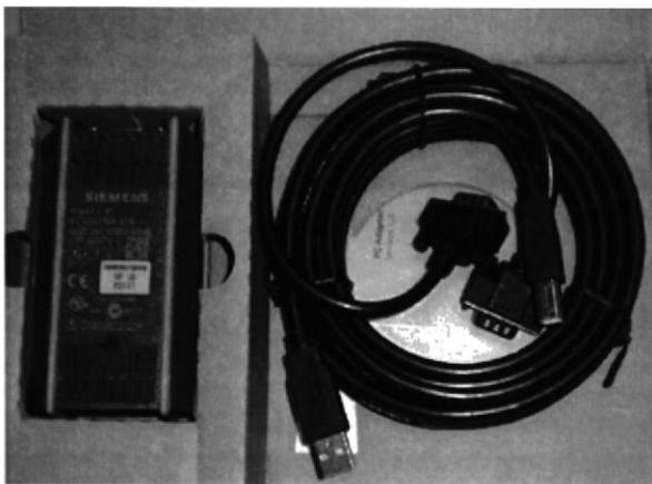
Figura 3.7 Cable PC adapter MPI, más el cd instalador.
