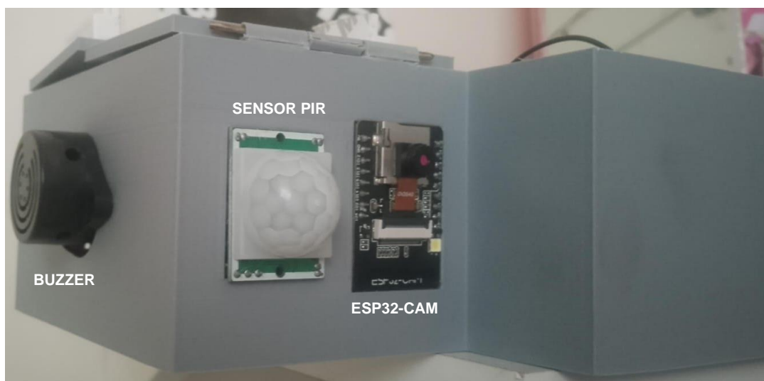
Figura 3.2 Implementación del sistema IoT (Vista Lateral)
