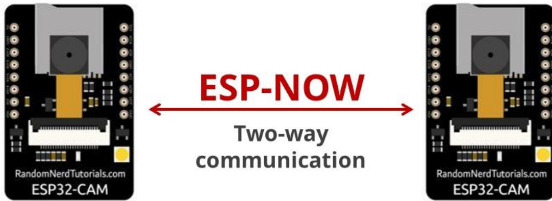
Figura 1.4 Comunicación ESP-NOW en dos direcciones [13]
