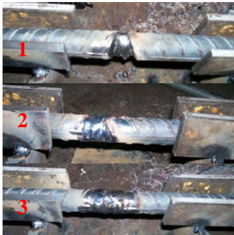
Figura. 3.5 Secuencia de soldadura.
