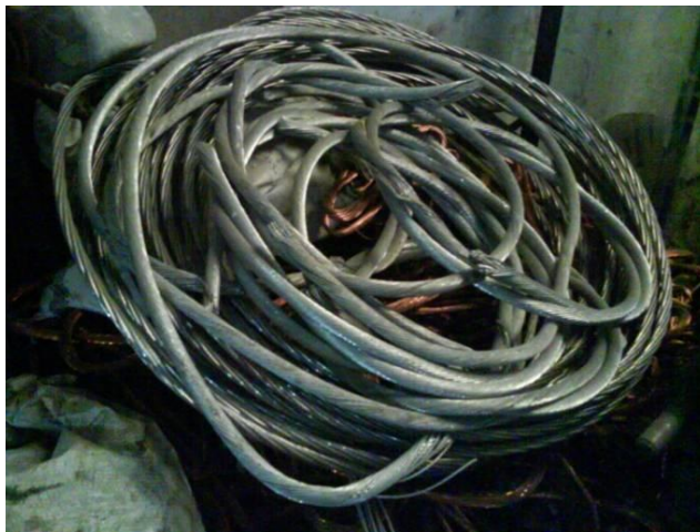
FIGURA 2.4. ALUMINIO DE DESECHO PROVENIENTE DE CABLES CONDUCTORES ELÉCTRICOS
