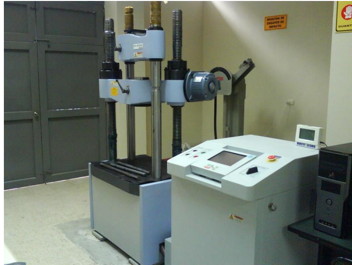
FIGURA 2.11. MAQUINA PARA ENSAYOS DE TRACCIÓN SHIMADZU UH 600 KNI UBICADA EN EL LABORATORIO DE ENSAYOS METALOGRAFICOS Y DE MATERIALES (LEMAT)
