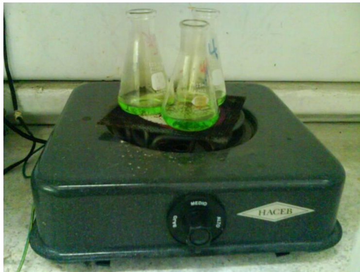
FIGURA 2.16. MUESTRAS EN REVERBERO PARA AYUDAR A DISOLVER LAS MUESTRAS EN LOS ÁCIDOS
