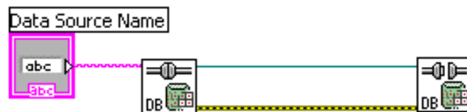
Figura 2.7.3.2 – Diagrama de Bloques de como abrir y cerrar una conexión a una Base de Datos
