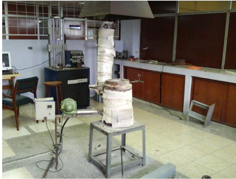
FIGURA 2.7. MINI HORNO DE CRISOL CON CONTROL AUTOMÁTICO DE TEMPERATURA EN EL LABORATORIO DE PROCESOS DE MANUFACTURA DE INTRAMET
