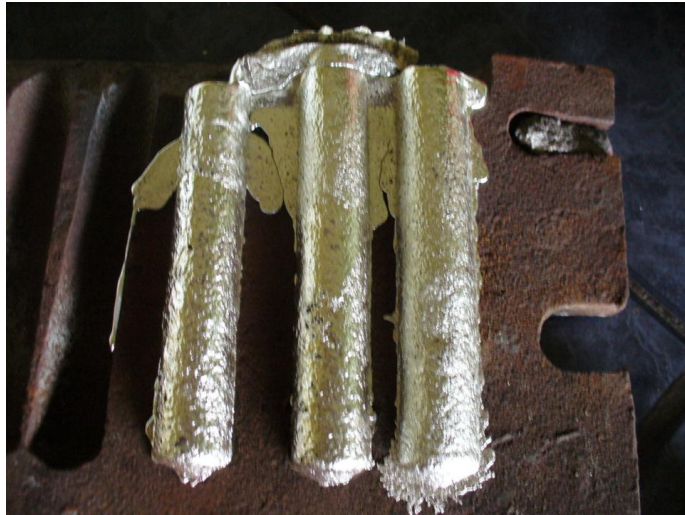
FIGURA 2.9. MOLDES METÁLICOS UTILIZADOS PARA COLADO DE LAS PROBETAS
