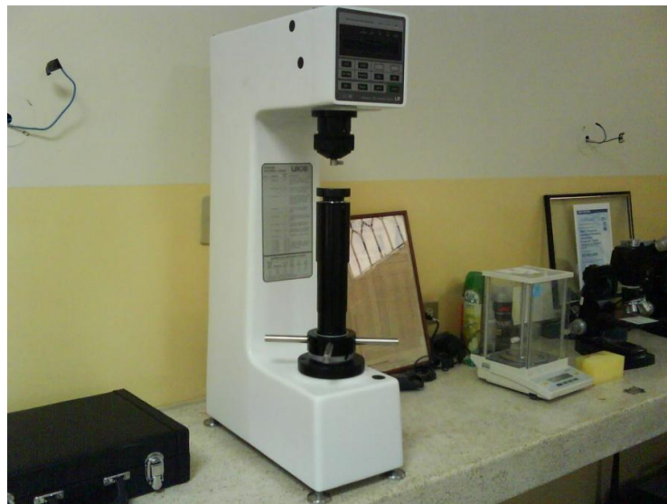
FIGURA 2.12. DURÓMETRO LECO UBICADO EN EL LABORATORIO DE ENSAYOS METALOGRAFÍCS Y DE MATERIALES (LEMAT)
