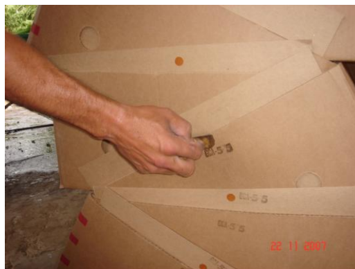
FIGURA 3.19 COLOCACIÓN DE CARULINA, SEÑO Y ESTIQUER EN CAJAS DE CARTÓN
