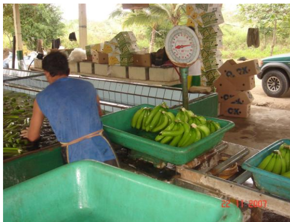
FIGURA 3.12 ENJUAGUE Y PESADO DE LAS MANOS DE BANANO CON CORONA PROCESADA
