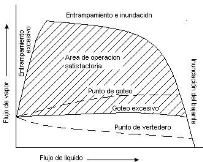
FIGURA 4.2 DIAGRAMA DE OPERACIÓN DE UNA BANDEJA PERFORADA
