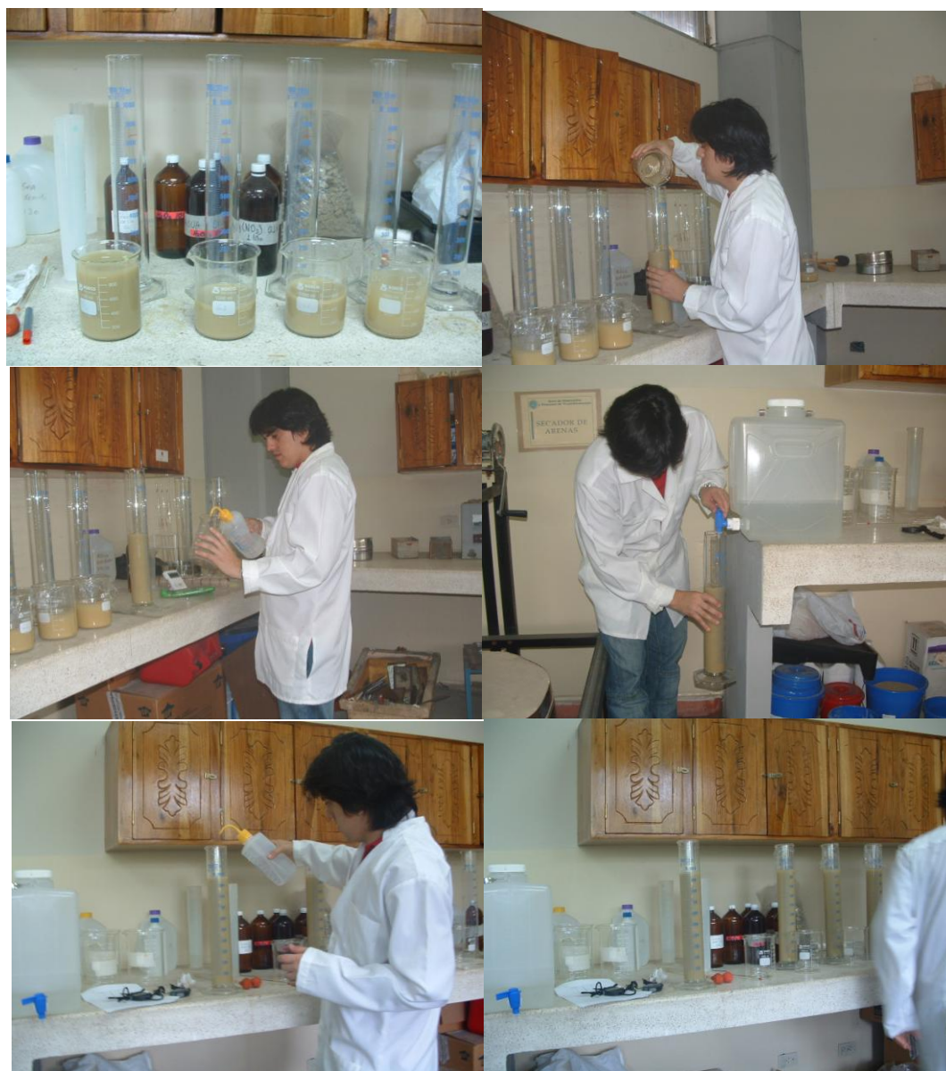
FIGURA 3.7. MUESTRAS LIBRES DE CARBONATOS Y MATERIA ORGÁNICA LLEVADAS DE LOS VASOS PRECIPITADOS A LA PROBETA DE 1000ML PARA INICIAR LA RECUPERACIÓN DE LA FRACCIÓN ARCILLA.
