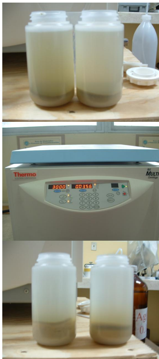
FIGURA 3.8. MUESTRAS DE ARCILLA CON CLORURO DE SODIO, CENTRIFUGACIÓN Y LAVADO. SE PUEDE OBSERVAR SU HINCHAMIENTO.
