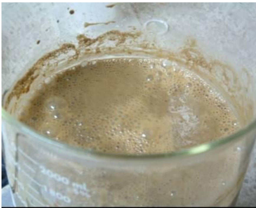
FIGURA 3.1. EFERVESCENCIA DE LA MUESTRA AL AÑADIR AGUA OXIGENADA.
