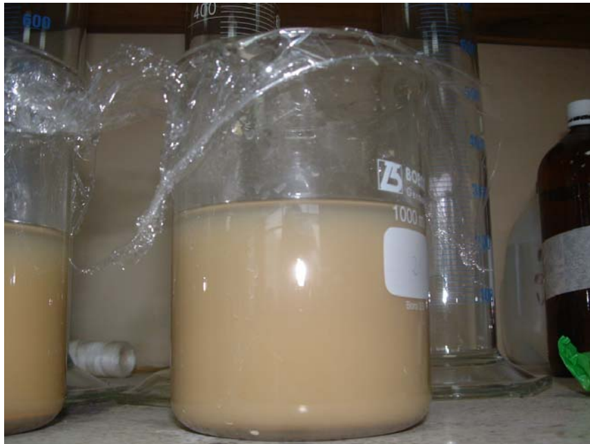
FIGURA 3.3. NO DECANTAMIENTO DE LAS MUESTRAS DESPUÉS DEL LAVADO.
