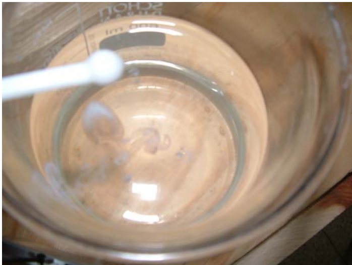
FIGURA 3.5. SOLUCIÓN LECHOSA FORMADA AL REACCIONAR EL \text{AgNO}_3 AÑADIDO AL AGUA DE LA FIGURA 3.4.
