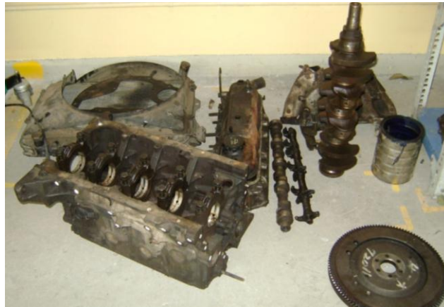
2-1. DESMONTAJE DEL MOTOR
