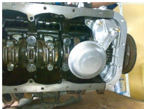
2-12. INSTALACIÓN DE BOMBA DE ACEITE
