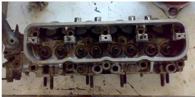
2-2. DESARMADO DEL MOTOR (CABEZOTE)
