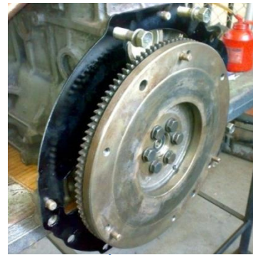
2-10 .INSTALACIÓN DEL VOLANTE DE INERCIA
