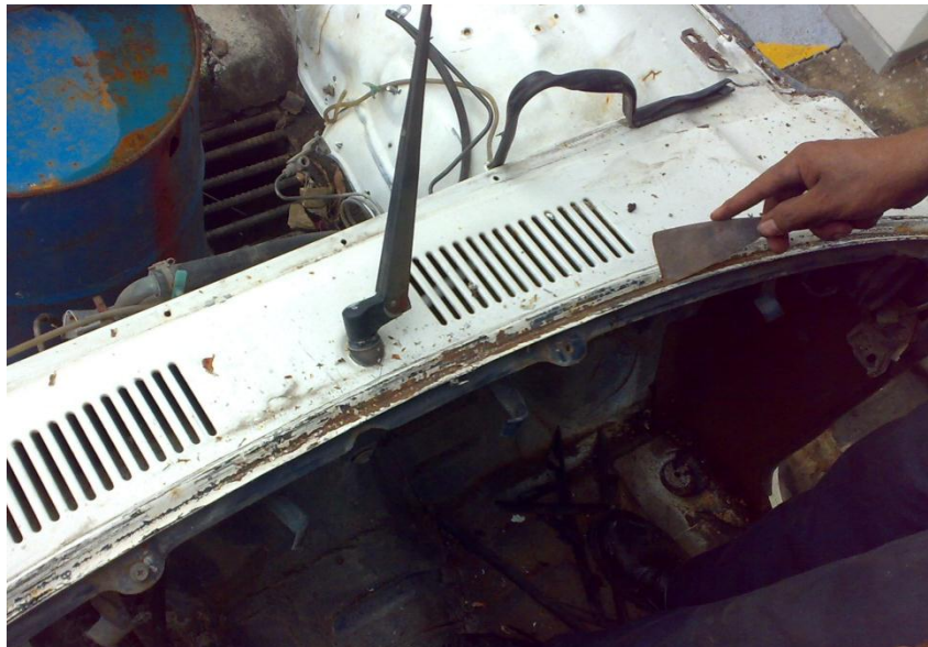
5-3 LIMPIEZA DE PARTES CORROÍDAS
