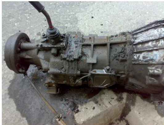
3-1 . LIMPIEZA DE CAJA DE CAMBIOS
