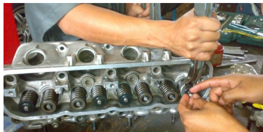
2-8. INSTALACIÓN DE RESORTES Y CHAVETAS DE VÁLVULAS
