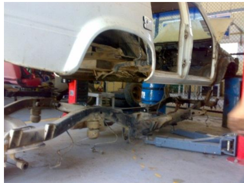
5-2 DESMONTAJE DE CARROCERÍA
