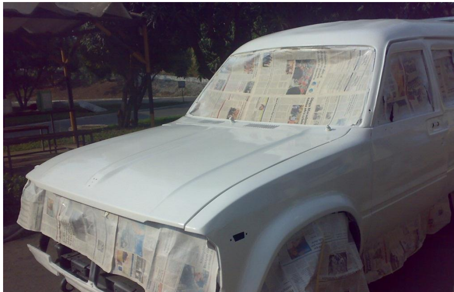
5-10 EMPAPELADO DEL VEHÍCULO PREVIO AL PINTADO
