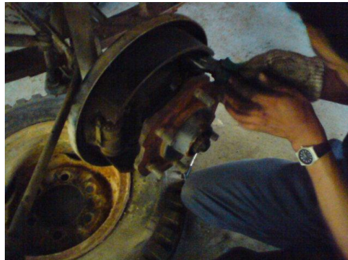
3-4 . DESMONTAJE DE ZAPATAS
