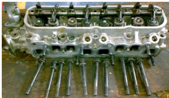
2-9. MONTAJE DE BALANCINES
