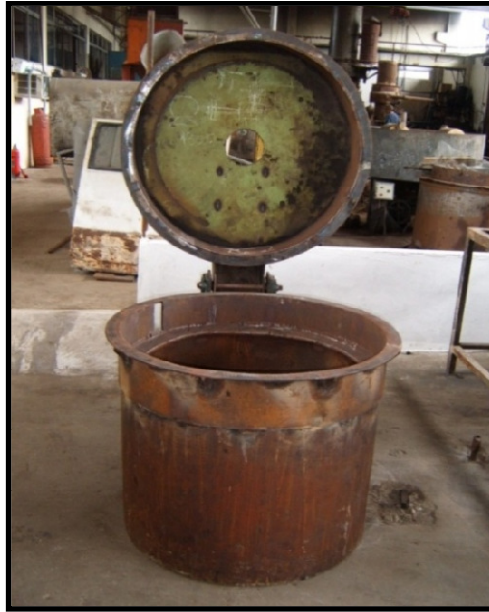
FIGURA 2.5 CONSTRUCCIÓN DEL BASTIDOR DE LA MÁQUINA CON ANILLOS DE REFUERZO
