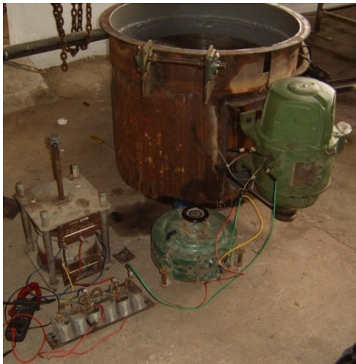
FIGURA 2.54 SISTEMA DEL MOTOR CON REÓSTATO Y RECTIFICADOR DE VOLTAJE
