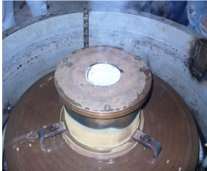
FIGURA 3.3 MOLDE INSTALADO EN LA MESA GIRATORIA.
