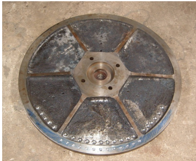
FIGURA 2.22 MESA GIRATORIA YA FUNDIDA Y MAQUINADA
