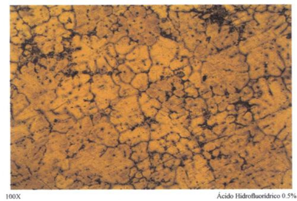
FIGURA 3.19 MICROESTRUCTURA FUNDICIÓN CENTRÍFUGA DE ALUMINIO A 800 RPM
