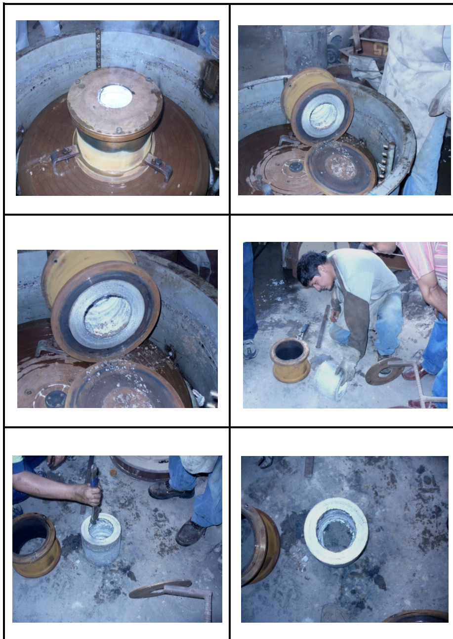
FIGURA 3.15 DESMONTAJE DE LA PIEZA FUNDIDA DE ALUMINIO.
