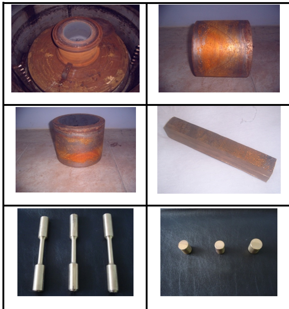
FIGURA 3.21 ETAPAS PARA LA ELABORACIÓN DE LAS PROBETAS PARA EL ENSAYO DE TRACCIÓN, DUREZA Y METALOGRAFÍA EN LAS PRUEBAS DE BRONCE.
