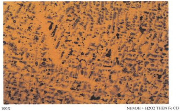
FIGURA 3.22 MICROESTRUCTURA FUNDICIÓN DE BRONCE EN ARENA.
