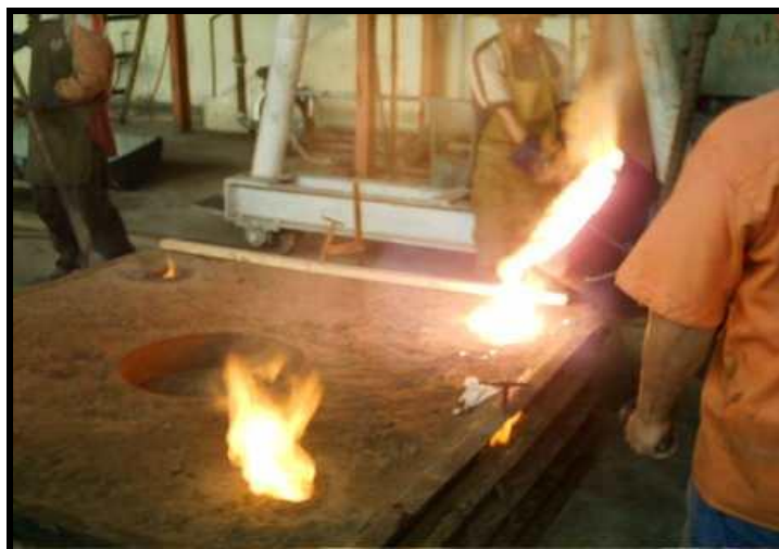
FIGURA 2.8 PROCESO DE COLADO DEL METAL
