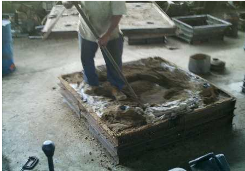
FIGURA 2.9 PROCESO DE DESMOLDEO
