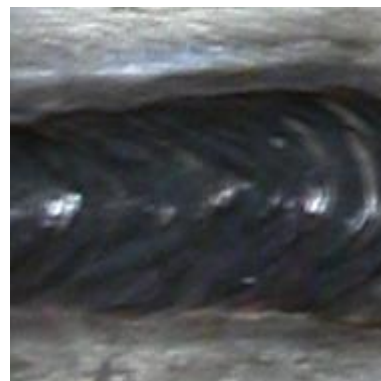
Figura 3.3.1.2 Cordón 2 usando soldadura TIG
