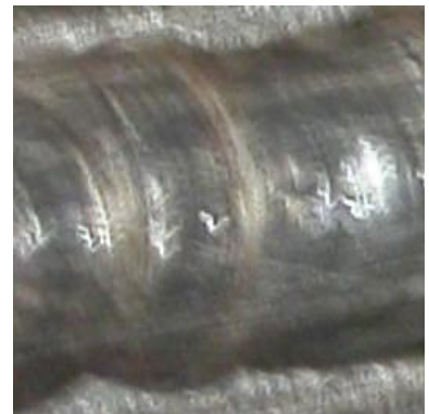
Figura 3.3.1.8 Cordón 8 usando soldadura TIG
