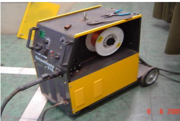
Figura 3.2.1.4 Máquina Smashweld 316 para Soldadura Semi-automática MIG/MAG y Tubular
