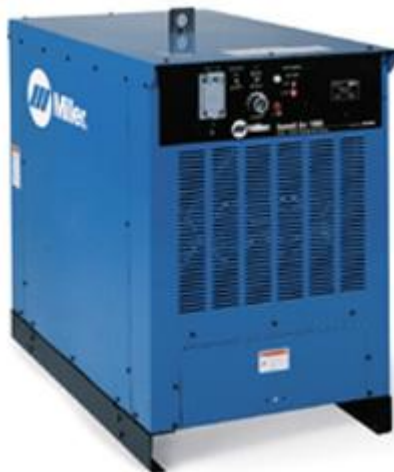
Figura 3.5.1.1 Equipo de SAW utilizado en la práctica
