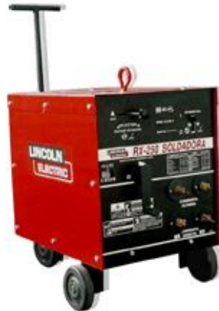
Figura 3.1.1.2 Máquina para soldar SMAW
