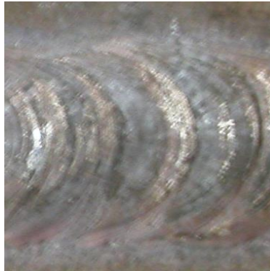
Figura 3.3.1.5 Cordón 5 usando soldadura TIG
