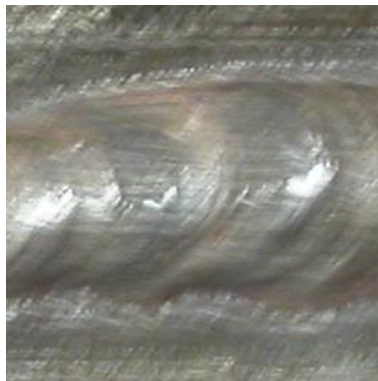
Figura 3.3.1.7 Cordón 7 usando soldadura TIG
