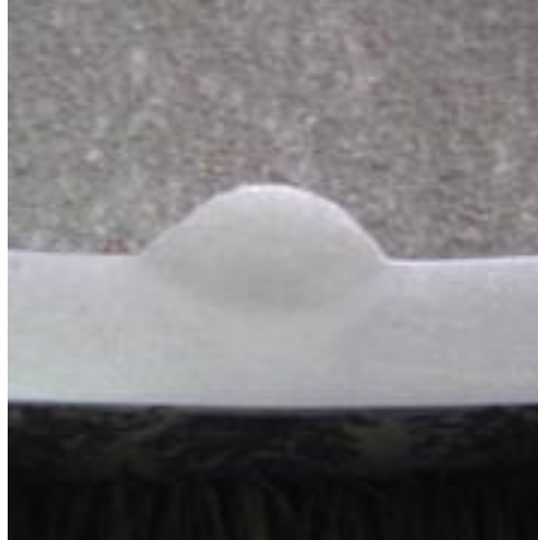
Figura 3.2.1.1 Corte transversal de cordón con CO 2 como gas protector
