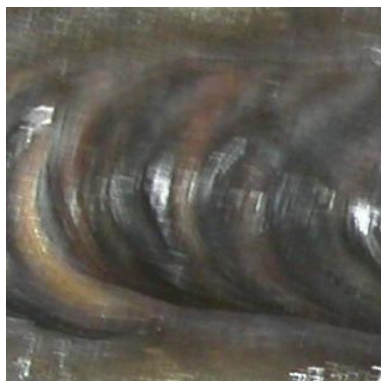
Figura 3.3.1.1 Cordón 1 usando soldadura TIG
