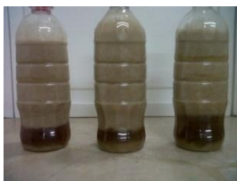
Figura 4. Prueba de aditivos CMC
