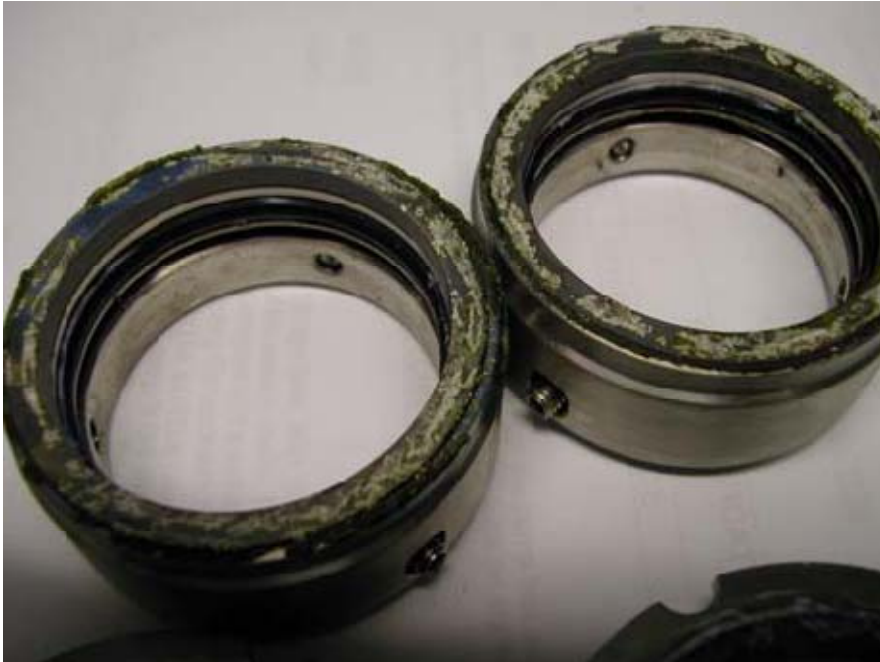
Fig.3 El ataque químico produce corrosión generalizada de los componentes del sello.
