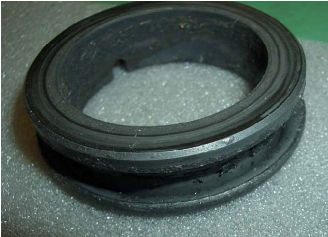
Fig.4 La corrosión por fricción se produce por vibraciones debajo del sello secundario estático.
