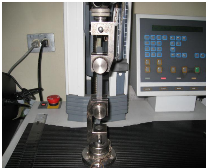
FIGURA 3.6 UBICACIÓN DE LA TIRA EN LA MÁQUINA DE ENSAYO DE TRACCIÓN Y ELONGACIÓN
