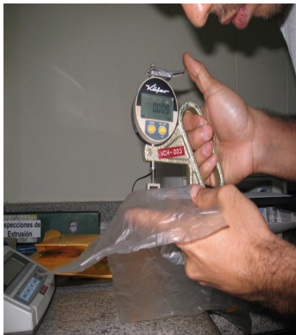
FIGURA 3.11 MEDICIÓN DE ESPESORES EN SECCIONES DE PRUEBA
