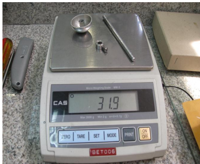
FIGURA 3.13 PESAJE DE LA CABEZA HEMISFÉRICA DEL ANILLO Y DEL VÁSTAGO DEL DARDO
