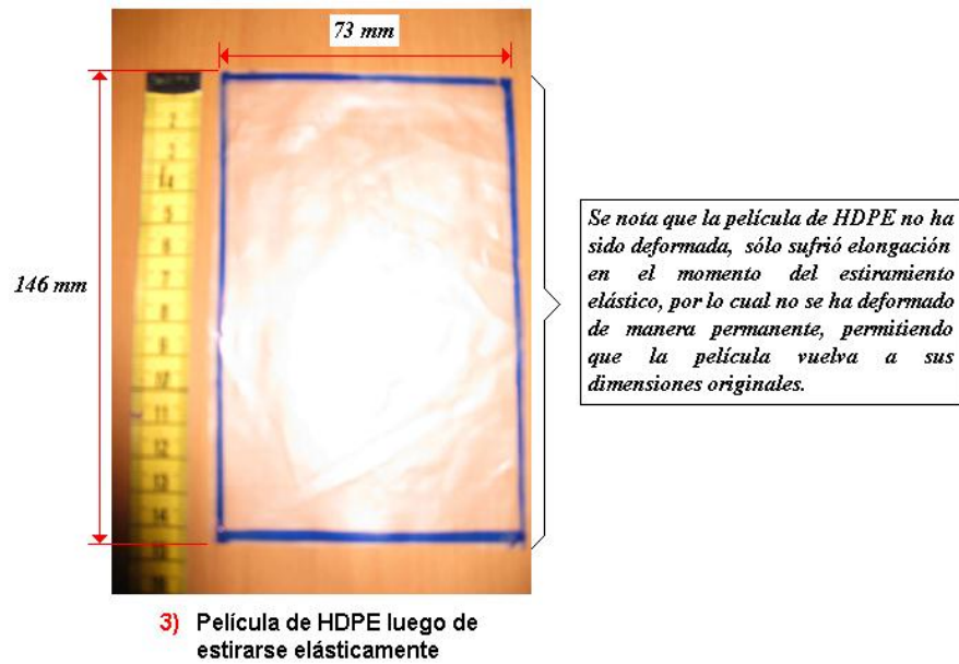
FIGURA 2.63 PELÍCULA DE HDPE LUEGO DE ESTIRARSE ELÁSTICAMENTE
