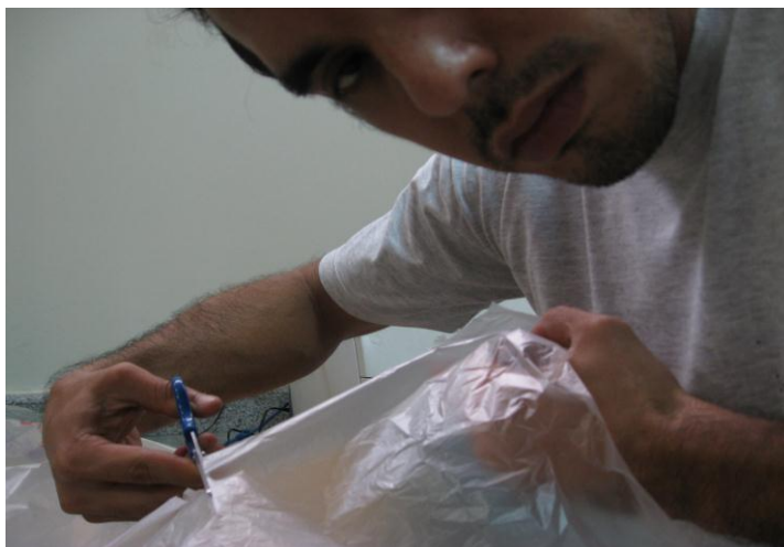
FIGURA 3.9 CORTE DE TIRAS DE LAS MUESTRAS
