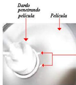
4) Inicio de Deformación Plástica
