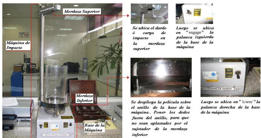
(1) Preparación de la Máquina de Impacto
