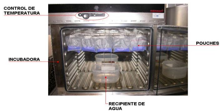
FIGURA 3.20 PESAJE, SELLADO TÉRMICO E INTRODUCCIÓN DEL POUCH EN LA INCUBADORA
