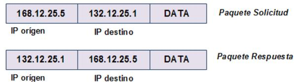
**Figura 4.20. Paquetes de solicitud y envío de respuesta en ataque IP Spoofing**
