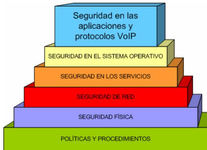
**Figura 4.7. Arquitectura de Seguridad para Telefonía IP**
