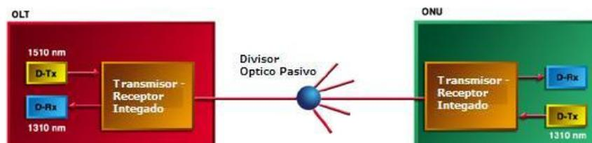
Figura 3.23. GEPON con dos longitudes de onda (12)
