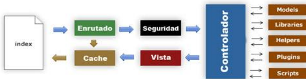
Figura 15. Arquitectura Modelo Vista Controlador (MVC)
