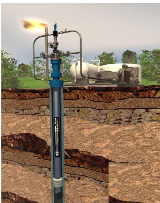
Figura 3-6: Representación gráfica del Sistema de bombeo hidráulico. Fuente: http://www.sertecpet.com.ec/public_html/esp/producto.php
