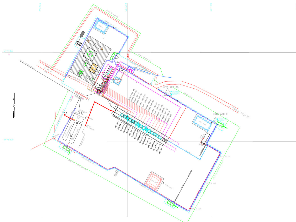
Figura 4-17: Esquema del Well Pad Fanny 20 ó Plataforma Productora Fanny 20, como se denomina al sitio donde se encuentra el grupo de pozos productores de nuestro análisis Fuente: Ingeniería de Facilidades de Producción Andes Petroleum Ecuador Ltd.
