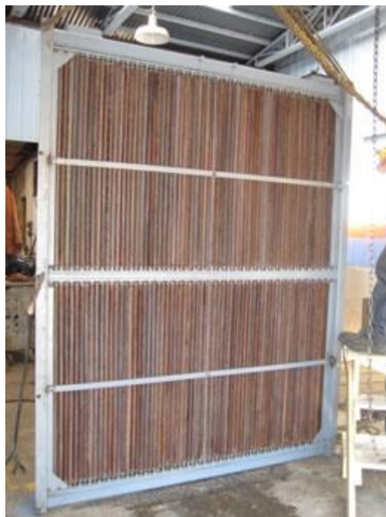
Figura 2.4 Radiador tipo industrial.
