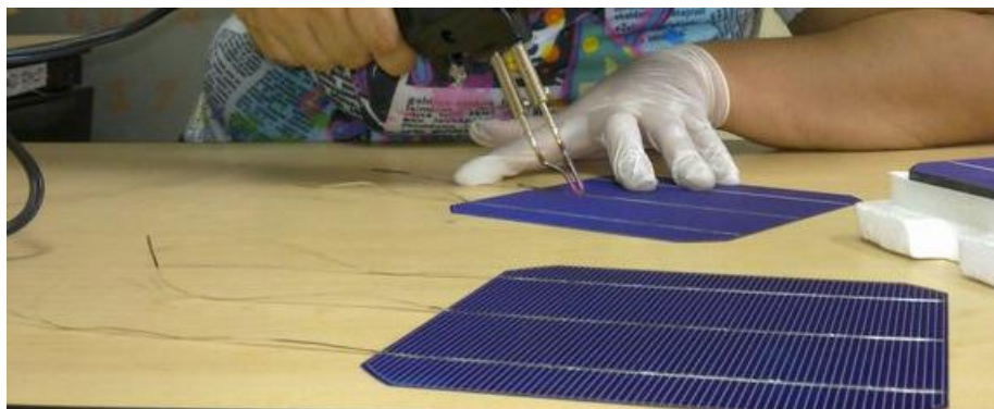
FIGURA 7.21 PROCESO DE SOLDADO DE LAS CELDAS FOTOVOLTAICAS.
