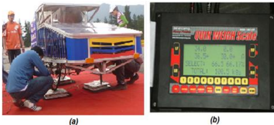
FIGURA 7.35 PESAJE DEL VEHÍCULO (A) VEHÍCULO SOLAR SOBRE LAS BALANZAS (B) PESO Y DISTRIBUCIÓN DEL MISMO
