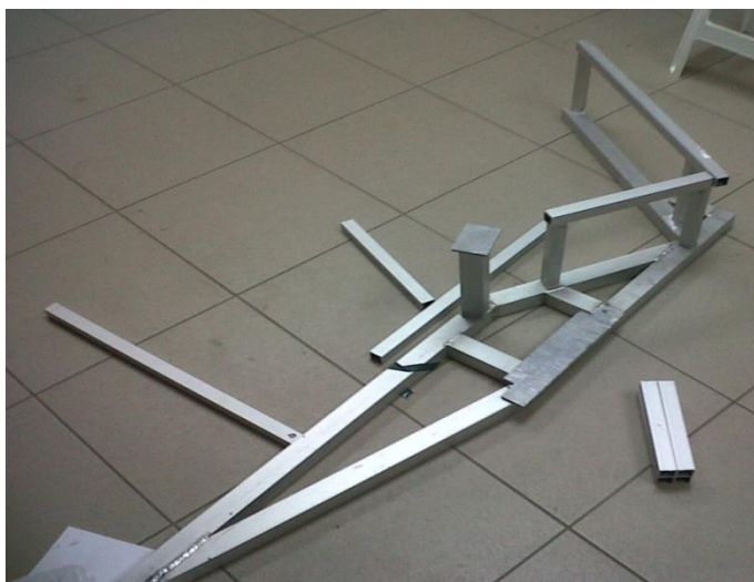
FIGURA 7.7 ARMADO DE LOS PERFILES DE ALUMINIO DEL CHASIS
