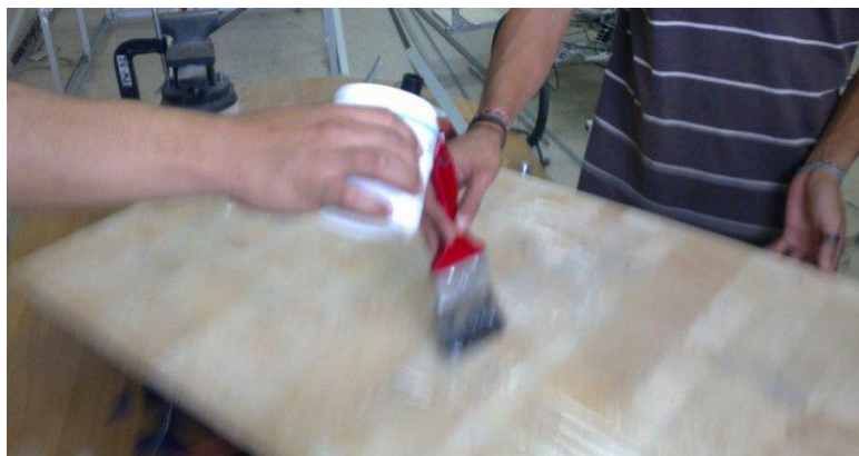
FIGURA 7.25 DISTRIBUCIÓN DE LA BASE SILICONA
