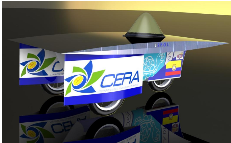
FIGURA 3.12 DISEÑO DE FORMA INICIAL DEL VEHÍCULO SOLAR
