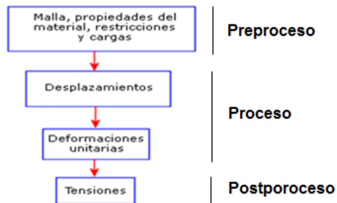
FIGURA 3.6 DIAGRAMA DE FLUJO POR EL MÉTODO DE ELEMENTOS FINITOS
