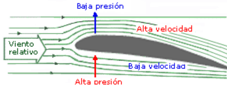
FIGURA 2.2 COMPORTAMIENTO DEL FLUJO EN EL ALA DE UN AVIÓN
