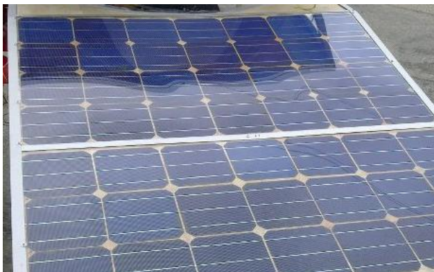
FIGURA 7.27 PANELES FOTOVOLTAICOS FINALIZADOS Y ENSAMBLADOS
