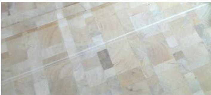
FIGURA 7.17 MADERA Balsa REFORZADA CON FIBRA DE VIDRIO Y RESINA
