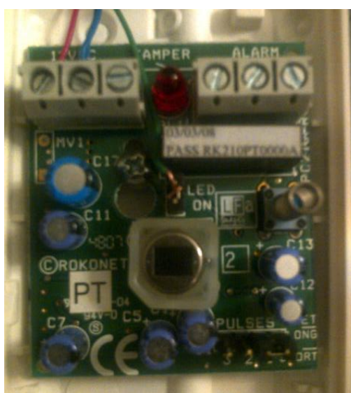
Figura 3-2 Circuito del Sensor de Movimiento
