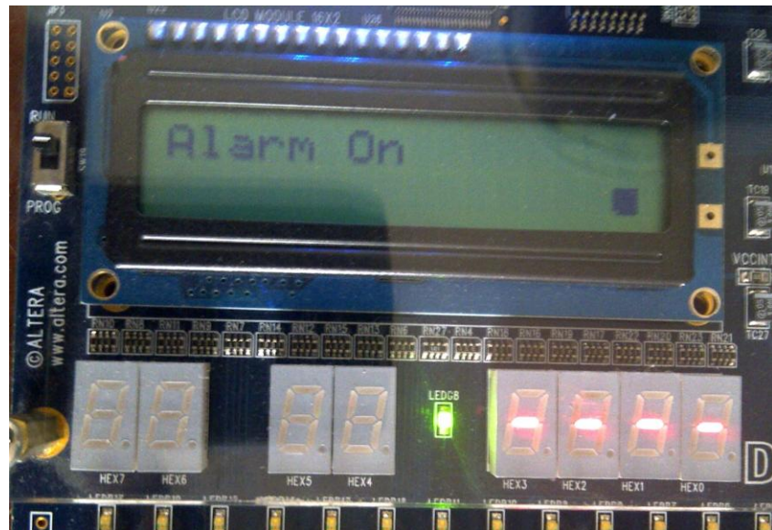
Figura 4-8 Sistema de alarma activado
