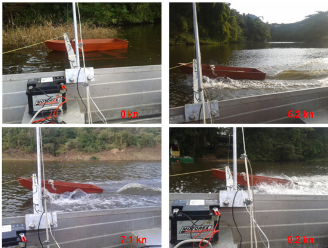
Figura No. 19 Prueba Experimental con el Modelo sin Flaps en Condición de Carga 1
