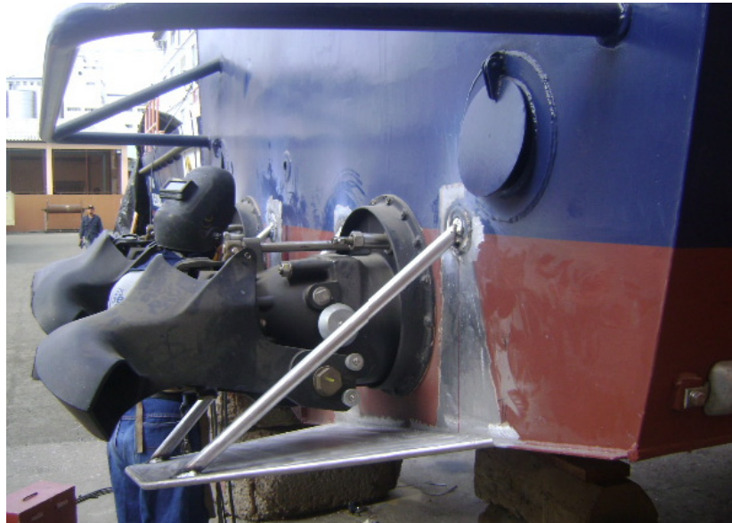
Figura No. 4 Flaps montados en Lancha Prototipo, [6]
