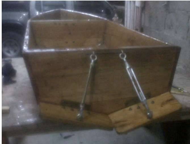
Figura No. 38 Modelo con Flaps, visto desde la Popa
