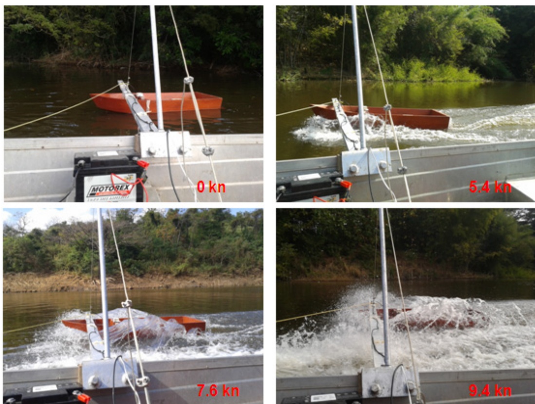
Figura No. 21 Prueba Experimental con el Modelo con Flaps a 10^\circ en Condición de Carga 1
