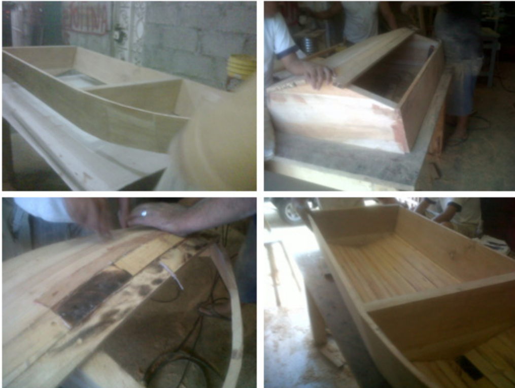
Figura No. 37 Construcción de Modelo de Lancha Prototipo
