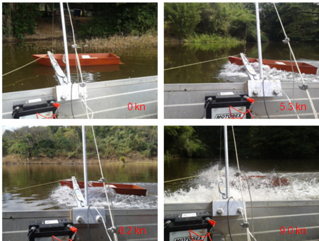
Figura No. 25 Prueba Experimental con el Modelo con Flaps a 5^\circ en Condición de Carga 2
