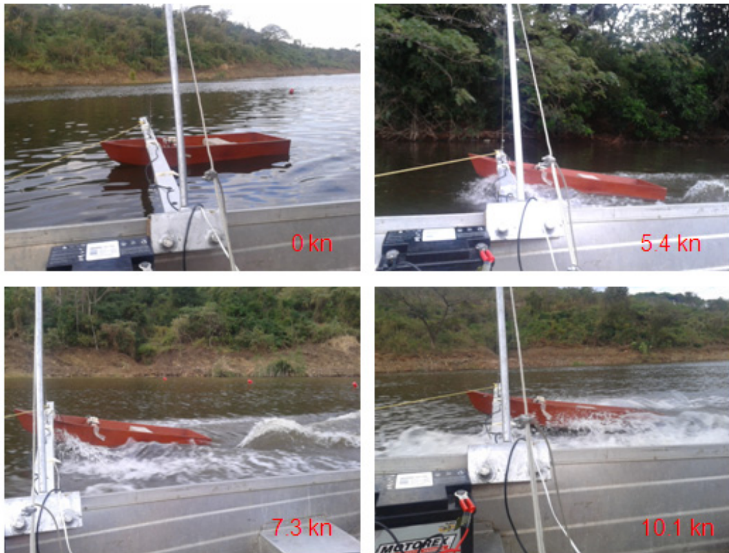
Figura No. 24 Prueba Experimental con el Modelo sin Flaps en Condición de Carga 2
