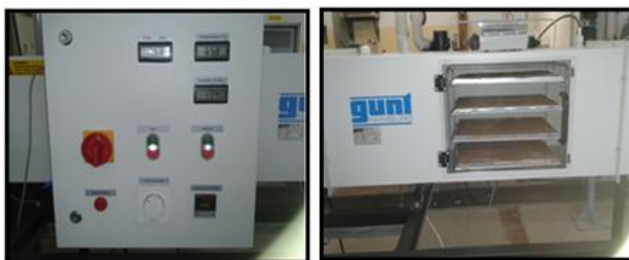
FIG. 4.2(a) PANEL DE CONTROL DEL SECADOR FIG. 4.2(b) MUESTRA FINAL 345 EN EL SECADOR
