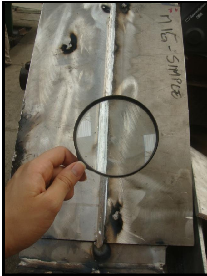
Figura 2. 15.- Inspección visual realizada en la probeta con ayuda de una lupa
