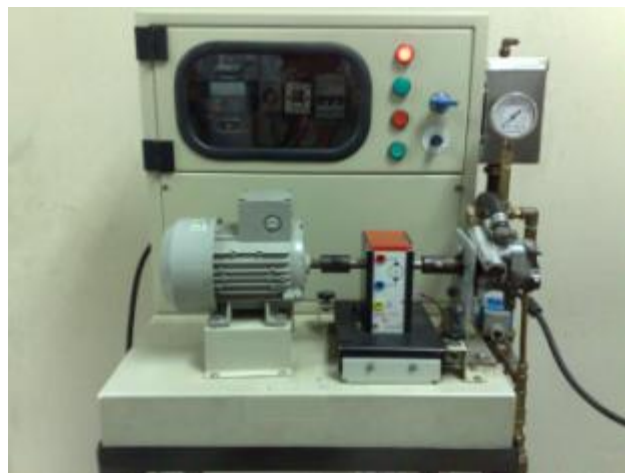
Figura 3.55 Planta de Control de Velocidad
