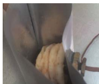
Figura 8. Ubicación del termopar en el camaron.
