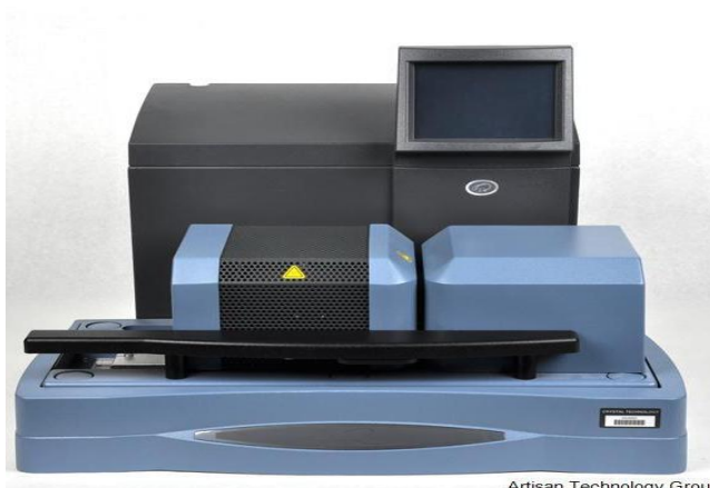
Figura 2.11 Esquema de una termobalanza para TGA
