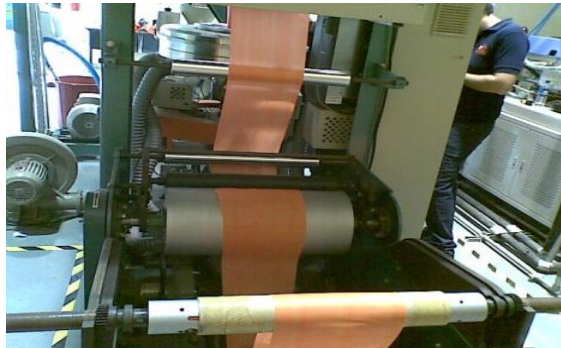
Figura 3.3 Enrollado de la película fina, laboratorio de procesamiento de plásticos de la ESPOL Fuente: Mario Baquerizo
