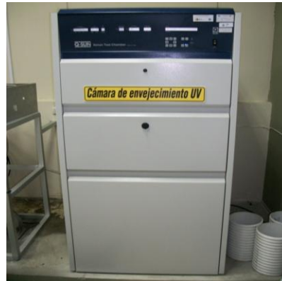
Figura 3.4 Cámara de envejecimiento artificial por radiación UV, LEMAT Fuente: Mario Baquerizo
