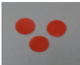
Figura 3.8 Dimensiones de las muestras para los ensayos de DSC/TGA Fuente: Mario Baquerizo
