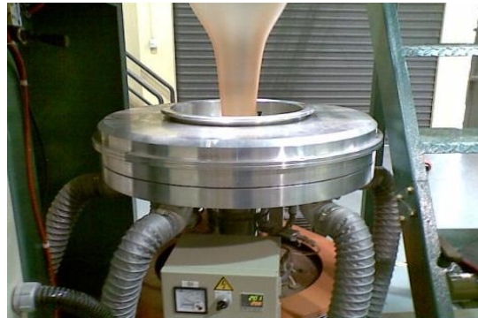
Figura 3.2 Soplado del material a través del orificio del dado, laboratorio de procesamiento de plásticos de la ESPOL
