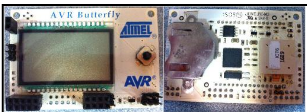
Figura 2.2.: Vista de doble cara de la tarjeta AVR Butterfly, desarrollada por el fabricante ATmega.
