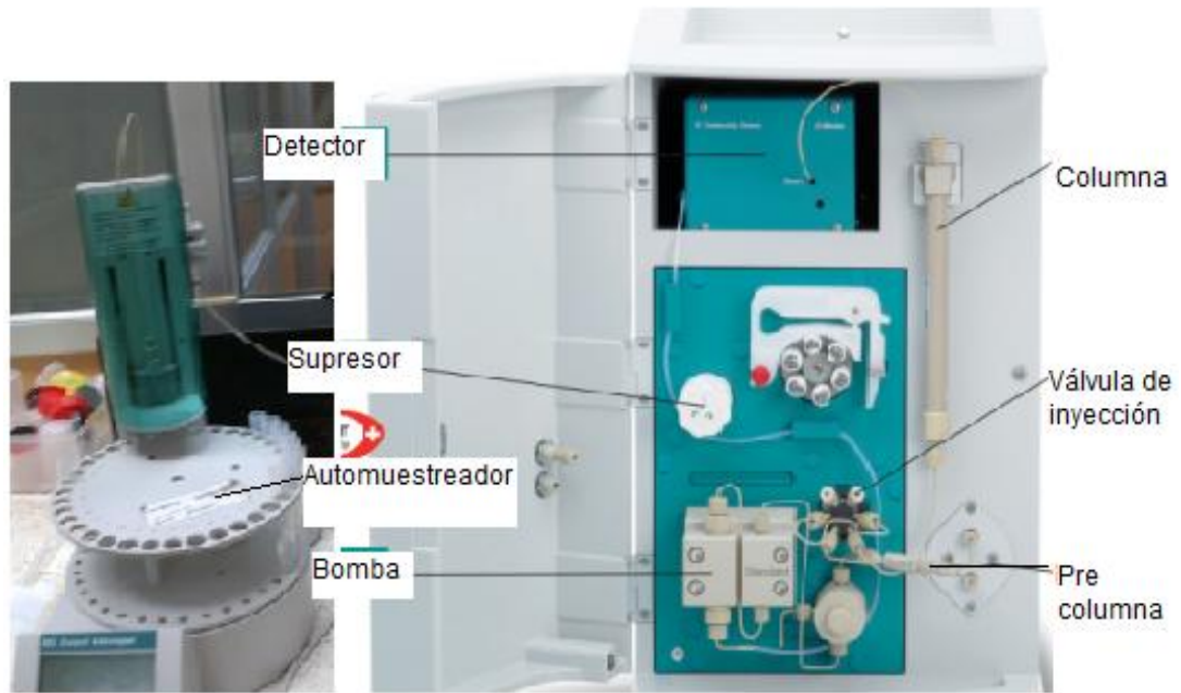
Ilustración 2. Componentes del cromatógrafo iónico
