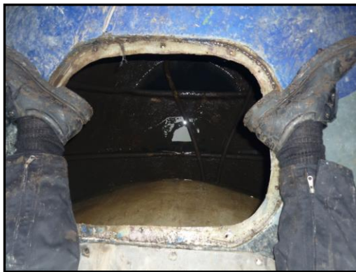
Figura 3.2. Compartimiento A, Tanque de libre inundación de proa
