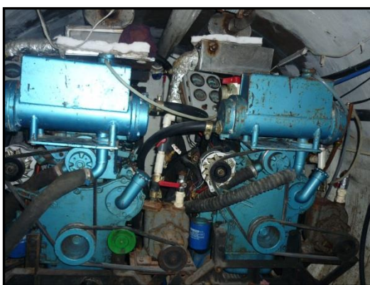
Figura 3.8. Maquinaria de propulsión diésel.
