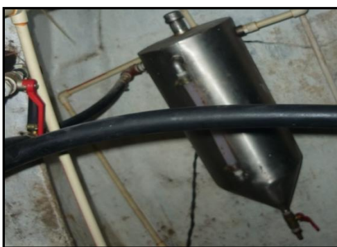
Figura 3.13. Separador de combustible.
