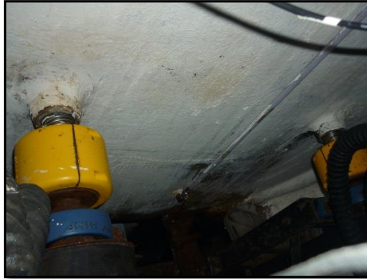
Fuente: Arias, I. Figura 3.9. Sello del eje de cola.
