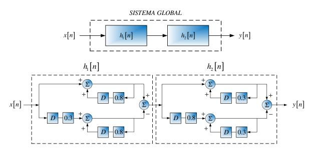
Al efectuar el análisis correspondiente, un estudiante de la materia Sistemas Lineales de la ESPOL, ha determinado que la respuesta impulso de cada sistema puede ser expresada de la siguiente manera:
