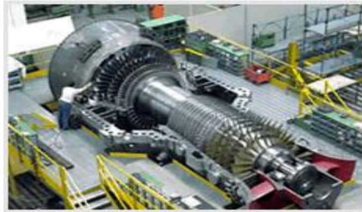
Figura 19. Turbina a Gas
