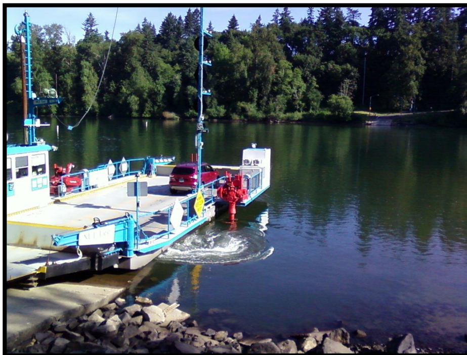
Figura IV.9 Barcaza usando unidades hidráulicas a los costados
