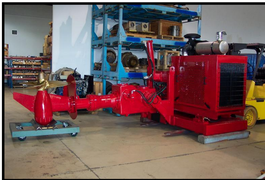
Figura IV.8 Unidad Hidráulica con propulsión azimutal
