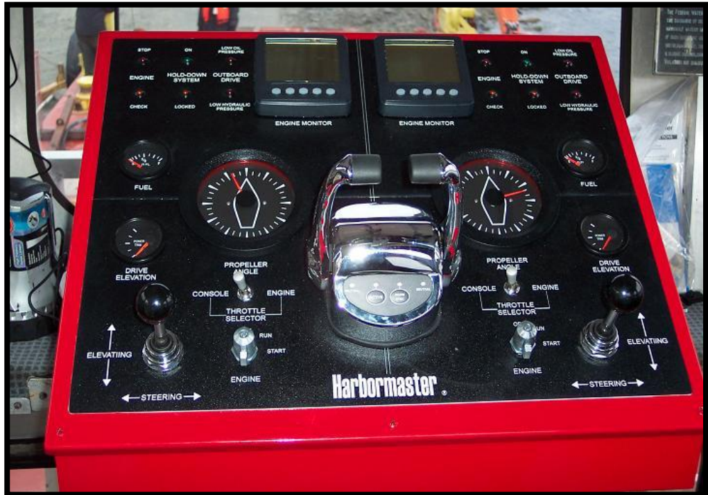
Figura IV.10 Control de mando de las unidades hidráulicas
