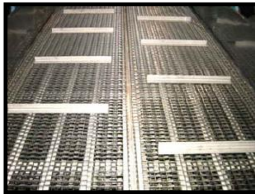
Figura II.8 Malla con retenedores instalados
