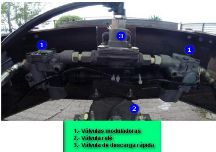
Figura 2. 83 Configuración típica en montaje de válvulas moduladoras ABS
