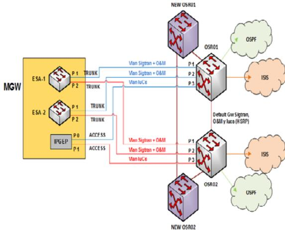
**Figura 5:** Diagrama estructural de un MGW
