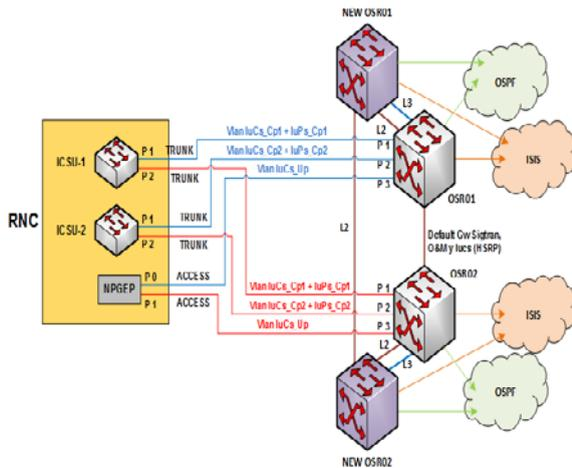
Figura 8: Diagrama estructural de una RNC
