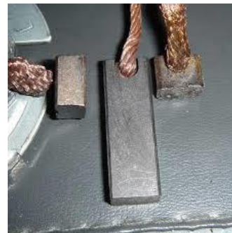
Figura 5. Carbones de motor de arranque.
