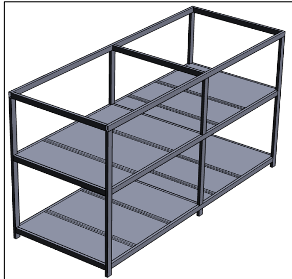
FIGURA 21. ESQUEMA ESTRUCTURAL DE CABINA INSONORIZANTE
