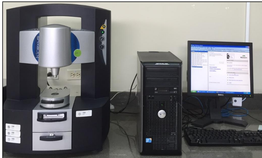
FIGURA 3. 1 REÓMETRO KINEXUS PRO, MARCA MALVERN, REALIZANDO EL ANÁLISIS DE UNA MUESTRA DE MASA DE HAI-0H.
