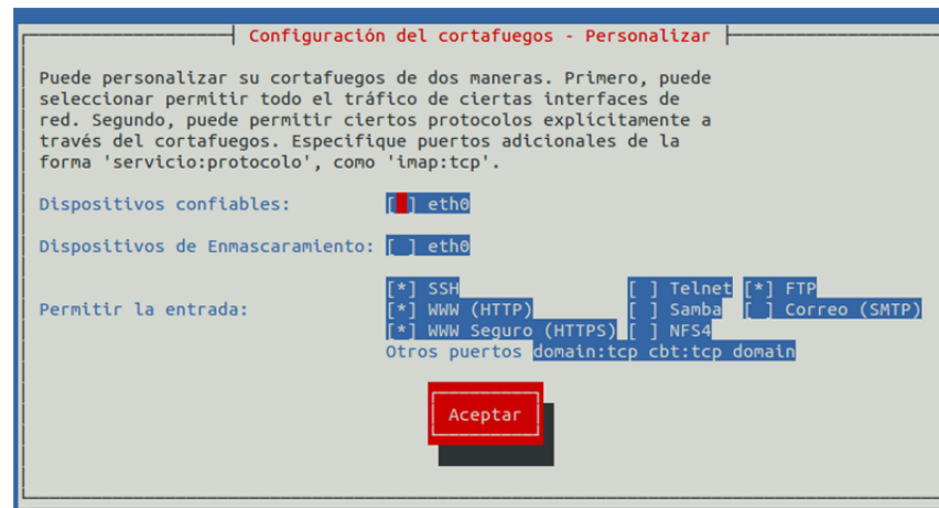
Figura 3-60. Configuración de Firewall Linux
