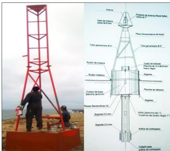
FIGURA 2.3 PARTES DEL SISTEMA ESTRUCTURAL
