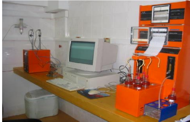
Figura 2.3: Análisis Rancimat con inyección de oxígeno a presión
