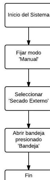
Figura 3.7 Diagrama de apertura de bandeja en modo manual
