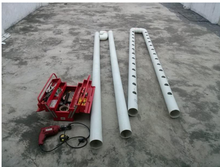
Ilustración 33. Materiales para la elaboración el kit hidropónico
