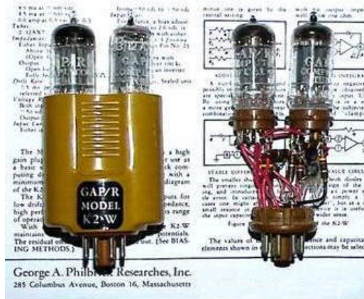
Fig. 1.20. Amplificador operacional de tubo
