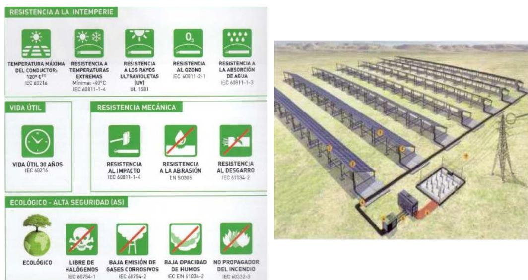
**Figura 2. 16 Características del Cable y su colocación [17]**
