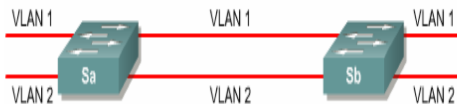
Figura 1.6 Enlace VLAN sin aplicar Trunking.
